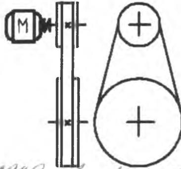
+ Ответ: *Ремённая передача, в лифтовой машине*
